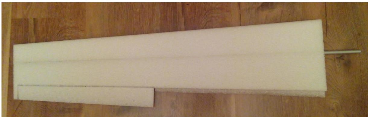
Wiederholen Sie das gleiche auch mit der zweiten Hälfte der Tragfläche. "Schließen" Sie die Hälften der Tragflächen, und kleben diese mit CA Kleber zu. Kontrollieren Sie auf einer geraderen Fläche (Tisch, Boden), ob beide Flügelenden das gleiche negative Verdrehen haben, oder ob der Flügel nicht irgendwie verbogen ist.
