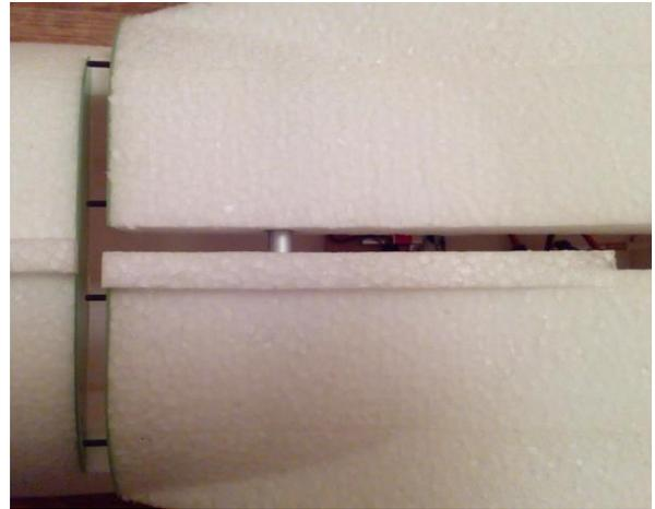
Schleifen Sie das Nasenprofil der Klappen in die korrekte Form, siehe Foto, und bringen sie an die Tragflächen an. Kleben Sie die Bolzen aus Stahldraht mit einem Tropfen dickflüssigerem CA Kleber.
