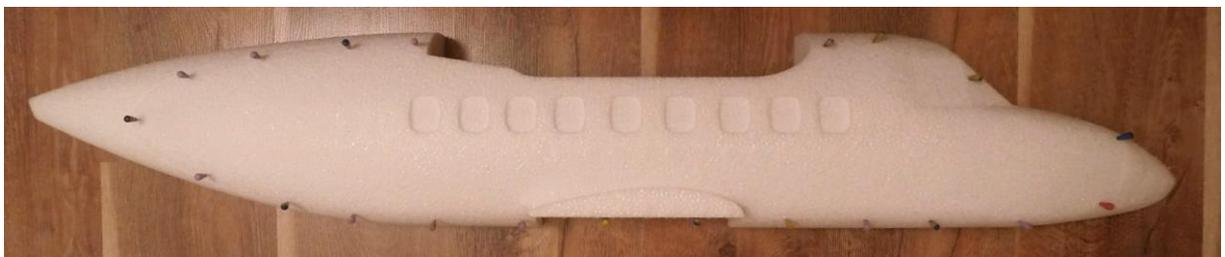
Nach dem Trocknen des PU Klebers (weiter nur PU) heben Sie das EPP in der Verbindungsstelle ein wenig an und kleben es sorgfältig mit CA Kleber bis zu den Kanten - damit beim Schleifen nicht die EPP Kügelchen ausgerissen werden.
