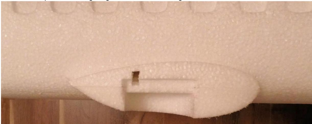
Danach verkleben wir das Fahrwerk ordentlich mit dem Rumpf, die ganze Fläche mit PU - in der Mitte, und CA - an den Rändern.
