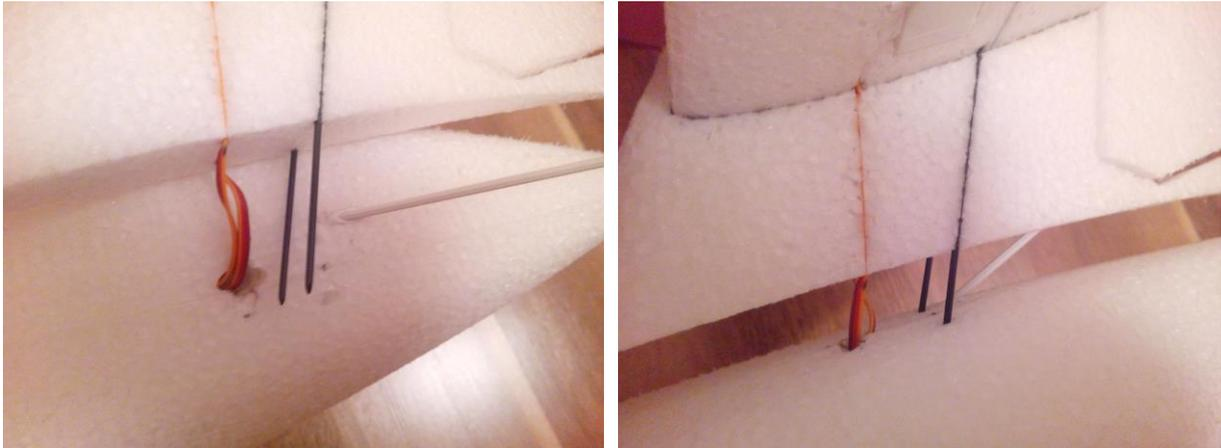
Drücken Sie den PU Kleber in die Öffnung für die Kohlefaserstangen rein, damit möglichst bestes verkleben erzielt wird. Kleben Sie die Leitwerke wieder in der Mitte mit PU Kleber und an dem Rand mit CA Kleber. Bevor der PU Kleber richten härtet, richten Sie die Leitwerke an die Mittellinie des Rumpfes.
