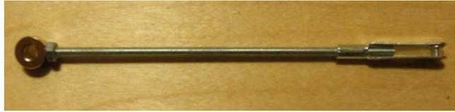
Schieben Sie die Zugstange auf die Schraube des Fahrwerks, siehe Foto. Nun passen Sie den letzten EPP Teil so an, dass sich das Fahrwerk frei bewegen kann und kleben ihn an.
