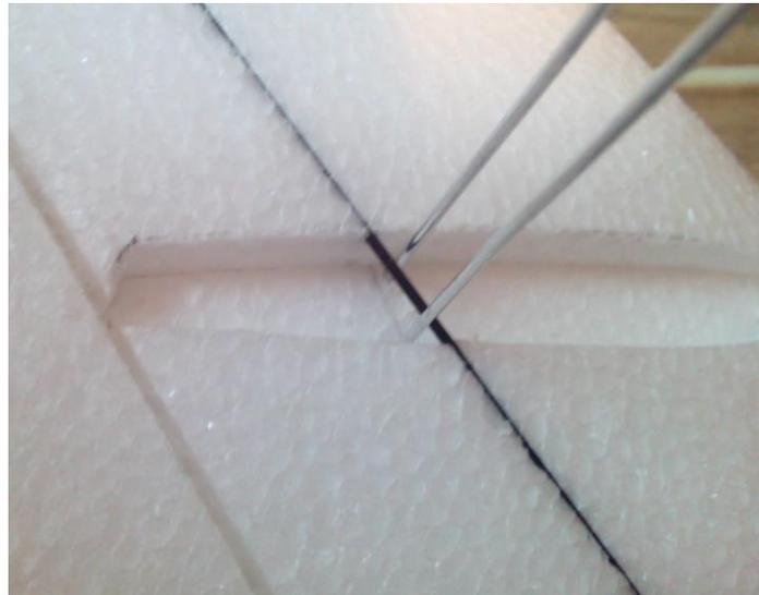
Bereiten Sie die Rillen nun auch in die zweite Hälfte des Höhenleitwerkes. Setzen Sie alles zusammen. Wenn alles passt, kleben Sie die Hälften des Höhenleitwerkes zueinander mit dem PU Kleber und mit CA Kleber sorgfältig die Alu-Drähte ein und das Höhenleitwerk zu dem Seitenleitwerk.
