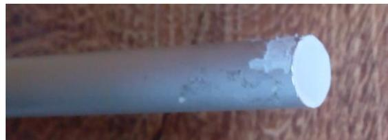
Das längere Aluminiumrohr drücken wir leicht mit einer Zange an, 23cm von der Flügelmitte. Damit wird versichert, dass die Flügelverbindung nicht weiter in das Rohr rutschen kann, siehe Foto.
