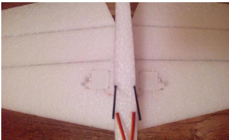
Versenken Sie die Höhenruderservos von unten in die Höhenflossen. Schneiden Sie die GFK Ruderhebel in die Höhenruder ein und verkleben in der Ebene der Servohebel ( GFK Hebel mit 3 Löchern). Sortieren Sie die Hebel, damit Sie nicht die Hebel für die Auftriebsklappen versehentlich in das Höhenruder kleben. Schneiden Sie die Kabel nur in das EPP ein, und führen Sie sie vor den Kohlefaserverstärkungen des Seitenleitwerkes wieder heraus.
