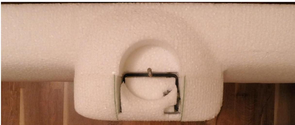
Schrauben Sie das Servo auf die Sperrholzplatte in „C“ Form an, dieses wird das Hauptfahrwerk einziehen. Benützen Sie den Metall - Servohebel und verbinden ihn mit der Zugstange. Die Sperrholzplatte mit dem Servo kleben Sie auf den Boden des Rumpfes, so dass sich die Zugstange nicht verklemmt (Die Servo Orientation ist hinter der Zugstange im Rumpf).
