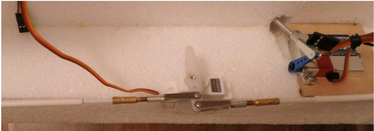
Die Anlenkung des Bugfahrwerkes muss, wie auf dem Foto abgebildet, fertiggestellt werden. Den Stahldraht mit einer Z-Biegung versehen, diese muss von außen über die kleine Achse geführt werden, sonst würde sich das Fahrwerk beim Schließen blockieren.
