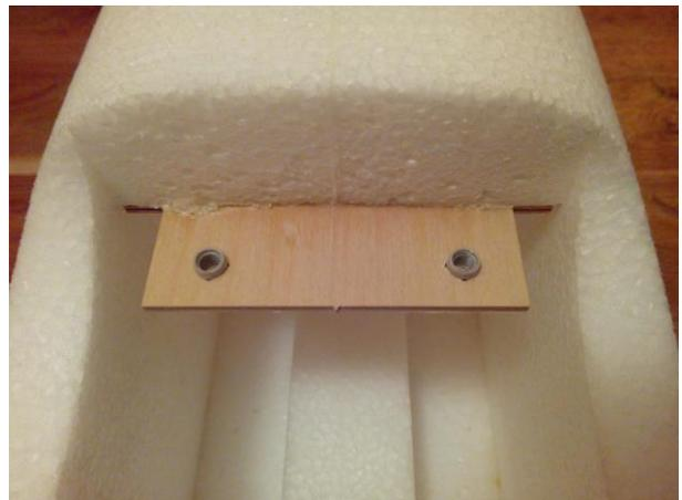
Kleben Sie die Verlängerung der Seitenflosse auf die Oberseite des Rumpfes. Schneiden Sie die Vorderkante der Seitenflosse leicht ab an der Stelle der Verlängerung. Kleben Sie die Verlängerung nur auf eine Hälfte der Flügelmitte. **Achtung auf das verkleben der Hälften der Tragflächen zueinander oder zum Rumpf.**
