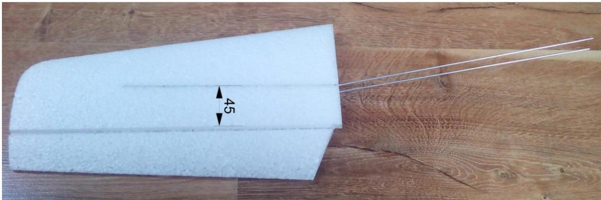
Schneiden Sie ein und verkleben Sie die Kohlefaserstangen mit dem Durchmesser 2mm und Länge mindestens 35cm in das Seitenleitwerk und lassen Sie sie ausreichend nach unten herausragen (5cm). Die Kohlefaserstangen müssen so platziert sein, dass sie durch die Verstärkung des Höhenleitwerkes laufen - siehe Foto.
