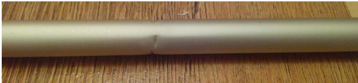
Rauen Sie das Rohr auf der ganzen Oberfläche auf, säubern es, und schieben in den Flügel. Öffnen Sie den Flügel so, dass Sie auf das Rohr PU Kleber auftragen können, und drehen Sie mit dem Rohr ein paarmal um, bis auf dem ganzen Rohr ein gleichmäßiger Klebefilm ist. (Nicht zu viel Kleber auftragen, damit er nicht bis auf die Flügeloberfläche rausschäumt). Wir lassen das Rohr überschüssig Richtung Flügelmitte genau bis zum Ende der Flügelmittelteilen.
