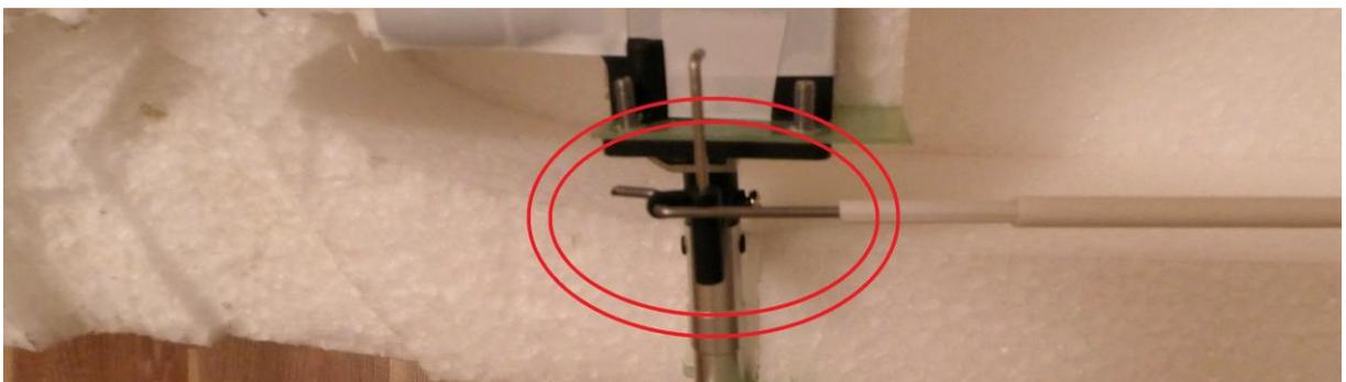
Nun verkleben Sie die beiden Rumpfhälften zusammen. Wieder mit PU und CA Kleber. Vergessen Sie nicht auch die linke Seite der GFK Platte des Bugfahrwerkes zu verkleben. Achten Sie darauf, dass kein Kleber in die Mechanik des Fahrwerkes gelangt!!! Es ist besser die Verbindungen mit einem Klebeband zu überkleben.
