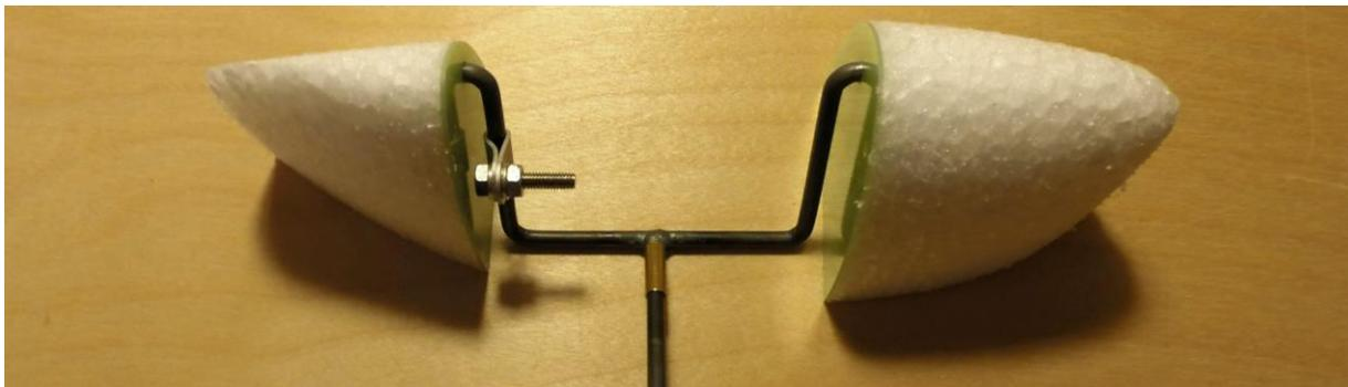
Setzen Sie alles zusammen und passen das mittlere EPP Teil so an, dass sich das Fahrwerk um 90° frei bewegen kann. Danach verkleben Sie die drei Teile.
