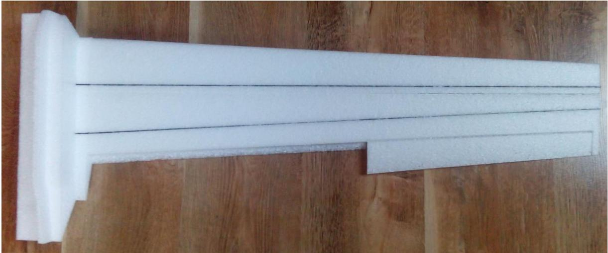
Zeichnen Sie die Mittellinie für die Motorgondel auf die Unterseite der Tragfläche parallel zur Flügelmitte, 145mm senkrecht von der vertikalen Kante an den Flügelmittelteilen. Von dieser Mittellinie schneiden Sie einen Tunnel als die Kabelführung. Bewahren das EPP, später mit diesem die Kabel zu verdecken. Brennen Sie mit einem heißen Draht von der Flügelmitte einen Kabeldurchlass, der bis zu dem Kabeltunnel reicht.
