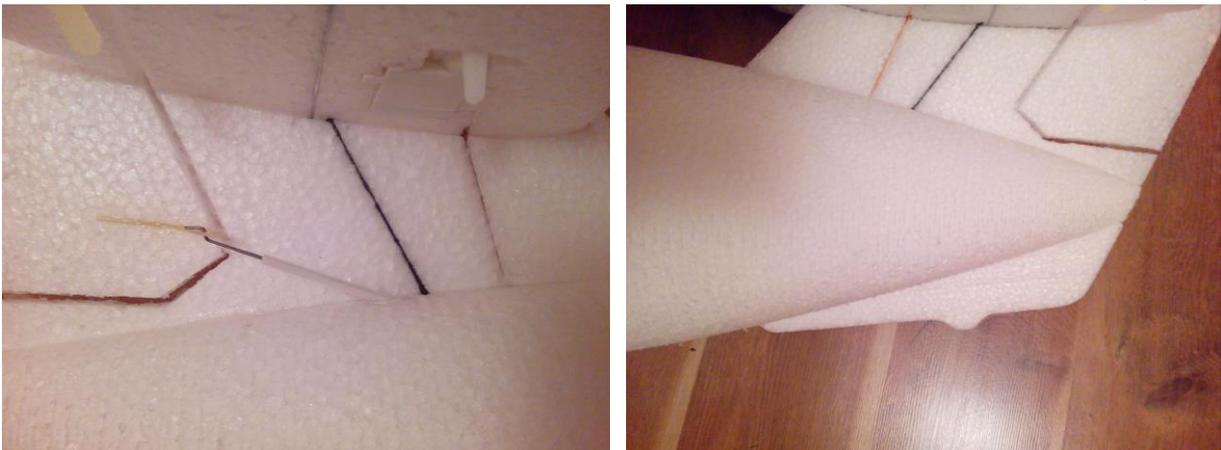
Nun kleben Sie die GFK Platte zum Befestigen der Tragfläche in den Rumpf. Rauhen Sie die zu klebende Seite der GFK Platte auf und kleben sie mit der ganzen Fläche an. Auf die Seitenflosse kleben Sie von beiden Seiten die "Antennen".
