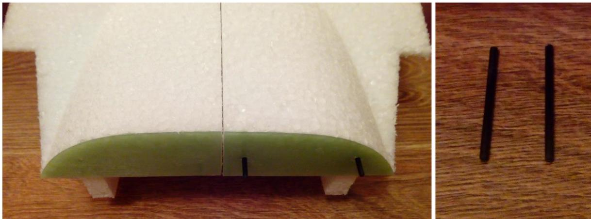
Legen Sie die Sperrholzplatte für die Tragflächenbefestigung auf die Unterseite der Flügelmitte und brennen mit einem heißen Draht die Löcher für die Schrauben durch.
