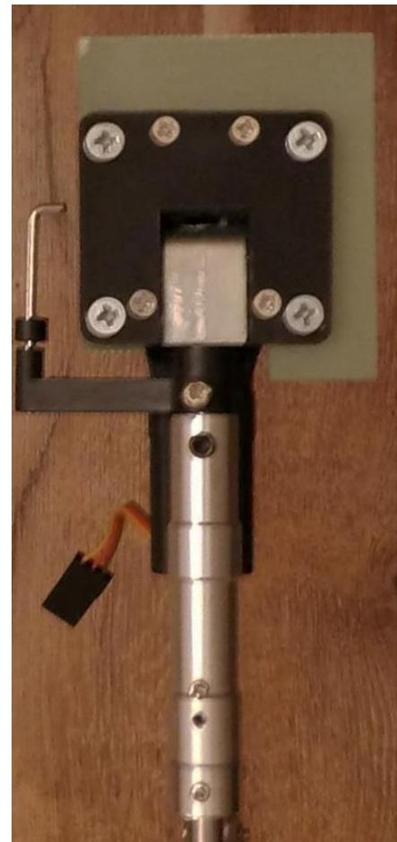
Weiter bereiten Sie sich das Hauptfahrgestell vor. Dieses besteht aus vier EPP Teilen und zwei GFK Platten. Die GFK Platten rauhen Sie von der zu klebenden Seite auf und mit der ganzen Fläche kleben Sie sie auf die Seitenteile aus EPP. Durch die Öffnungen in den GFK Platten brennen Sie das EPP mit einem heißen Draht durch, damit das Stahlfahrwerk und dessen Anschlag leicht einsetzbar sind.
