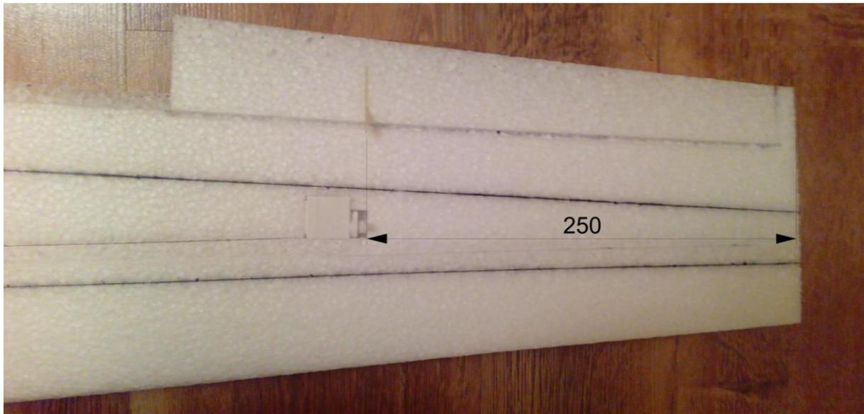
Kleben Sie in die ganze Länge der unteren Vorderkante der Klappen die Kohlefaserstange mit dem Durchmesser 4mm. Schneiden Sie danach die Scharniere ein (90° mit einem Loch) und **bei der Flügelmitte, das verlängerte/verbogene Scharnier zur Bedienung!!!** Die Scharniere müssen die Kohlefaserstange berühren und sind im Abstand von 140mm. Richten Sie alles mit Linear aus, und verkleben es mit CA Kleber.
