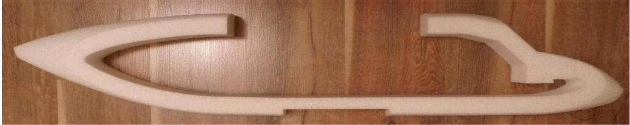
Zum Verkleben des äußeren Teiles des Rumpfes benutzen Sie den PU Kleber, damit Sie die zu klebenden Fläche korrigieren können. Den PU Kleber tragen Sie nur auf die inneren Kanten - siehe Foto, damit der Kleber nicht zu der Oberfläche aufschäumt. Wir meiden auch den vorderen und hinteren Teil, wo das EPP zu dünn ist und der PU Kleber durchschäumen kann.
