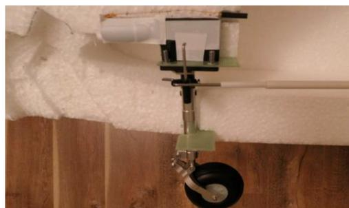
Bereiten Sie den Bowdenzug für die Seitenrudieranlenkung in dem hinteren Teil des Rumpfes vor. Dieser tritt etwa 15mm von der Mitte und 130mm vor dem Ende aus der rechten Rumpfhälfte aus, siehe Foto. Verkürzen Sie den Bowdenzug etwa in die Mitte des Rumpfes.
